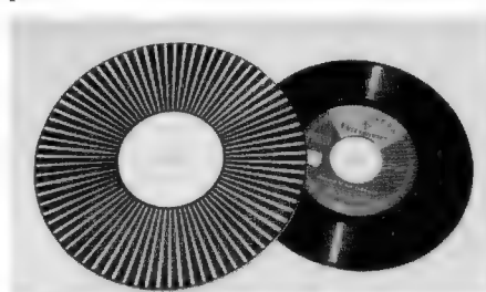
Bild 1. Stroboskopscheibe für 78 Umdr./min. neben einer handelsüblichen Schallplatte
